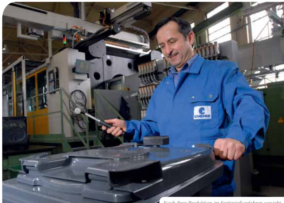
Nach ihrer Produktion im Spritzgießverfahren versieht Ismael Ünal die Tonne mit Rädern, Achsen und Deckel
